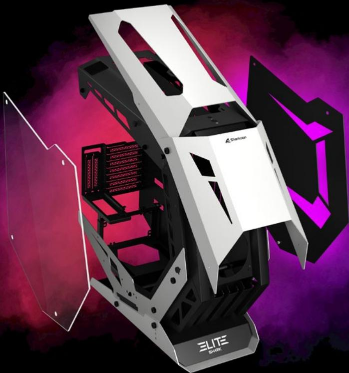
Das Seitenteil auf der rechten Seite verdeckt die Kabel, welche mit Expertise geschickt dahinter sortiert werden können. Das gläserne Seitenteil lässt sich hingegen dank einer Montagehalterung am unteren Ende problemlos und ohne größeren Aufwand ein- und ausbauen.
